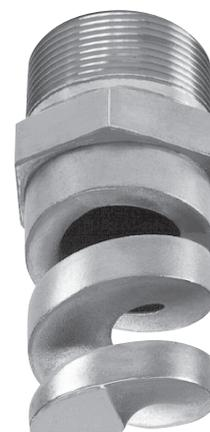
La buse TF est la buse originale en spirale conçue par Bête Fog Nozzle. Sa forme en spirale cisaille le liquide en plusieurs cônes creux qui convergent en un seul cône creux. La conception en spirale offre une excellente résistance au colmatage et tend également à atomiser le fluide mieux que les buses conventionnelles, ce qui permet d'obtenir des gouttes plus fines. Les buses TF à cône creux sont utilisées dans une grande variété d'applications, notamment :
